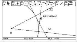
eine Senkrechte durch Schnittpunkte zu den jeweiligen Schenkeln konstruieren. Den Schnittpunkt der beiden Senkrechten definieren. Damit ist ein Punkt der Winkelhalbierenden konstruiert.
